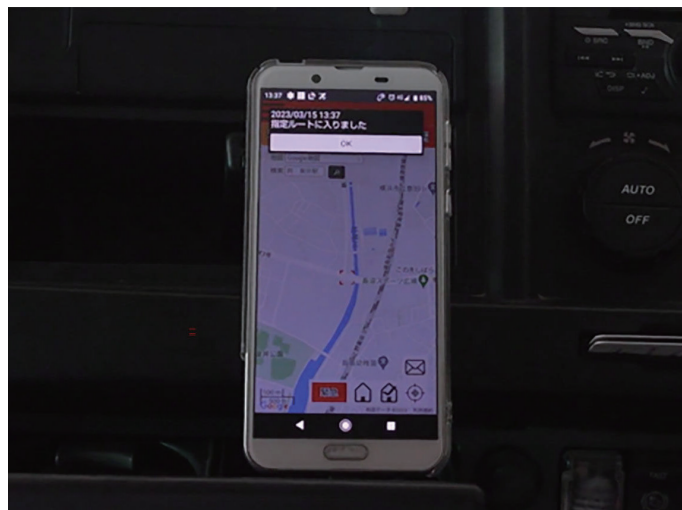
位置情報によってダンプトラックが指定エリアに入ったことをスマートフォンに通知
