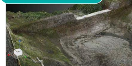
3次元設計データと点群データを点群処理ソフトウェア上で比較することで土量算出を行います。
