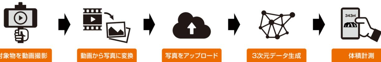
撮影した動画を写真に変換し、衛星による位置情報と合わせてクラウドにアップロードすることで、3次元データが生成され、現場で土量の計測結果を確認できます。
