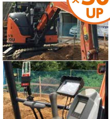
1人での作業が多く回転レーザーを使い、掘削高の確認はその都度重機から降りて確認する必要がありましたが、導入後はキャビン内から数値が分かるので時間短縮に繋がっています。使用現場が増えることに身体、コスト、施工時間など良い商品と実感しています。
