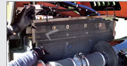
ラジエータ前ネット
