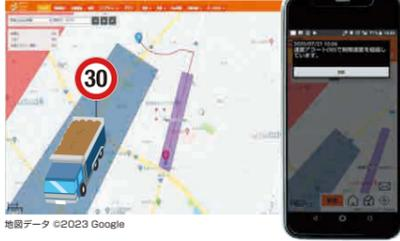
速度超過、ルート逸脱、不適切な駐車を検知しダンプトラック運転手と管理者に通知
