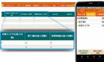
事前に設定した「積込場」/「荷下場」間の運搬回数を自動カウント。リアルタイムに進捗確認ができます。
